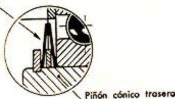
FIG. 58 - Montaje de las arandelas elásticas contra golpes
