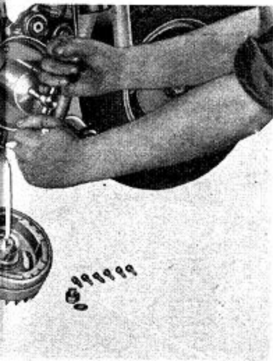
Desmontaje de la brida del volante magneto
